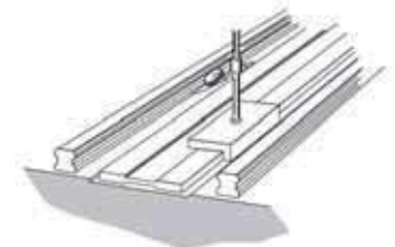
Fig 1.11.14 Use a straight edge
